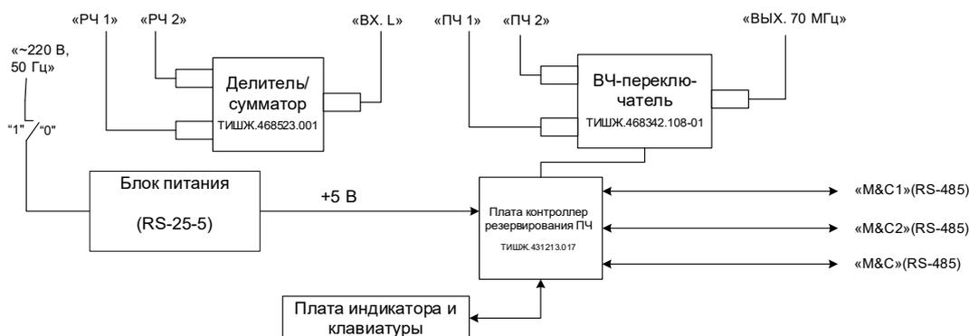
Рисунок 1.3 - Функциональная схема КРПЧ «вниз».
